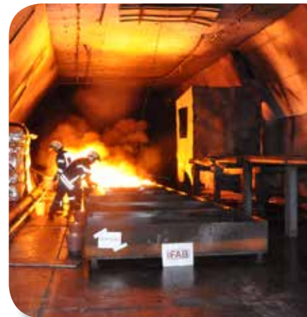
Tunnel Mont Blanc Brandversuche mit verschiedenen Brandbekämpfungssystemen
